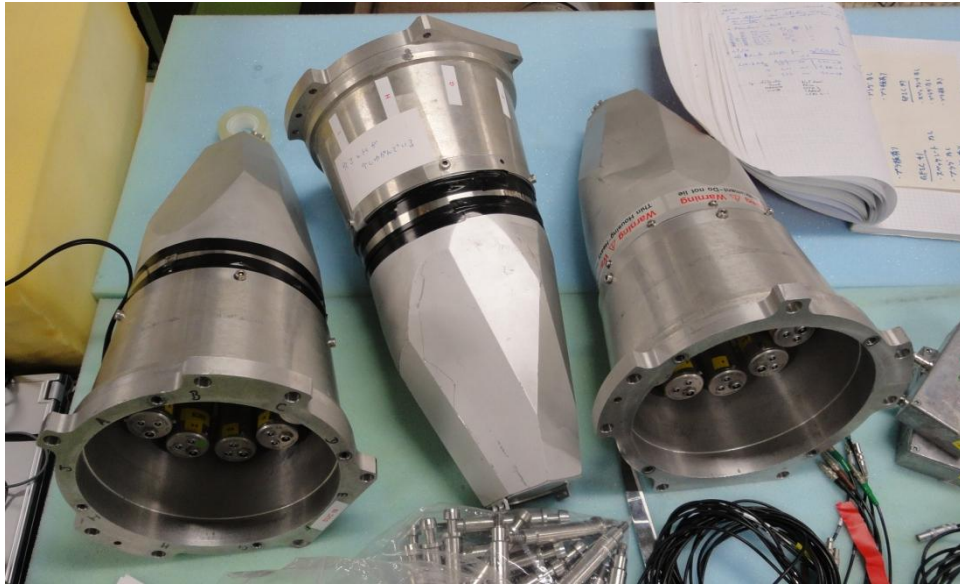
Fig. 3.7 実験で使用した BGO 検出器の写真
