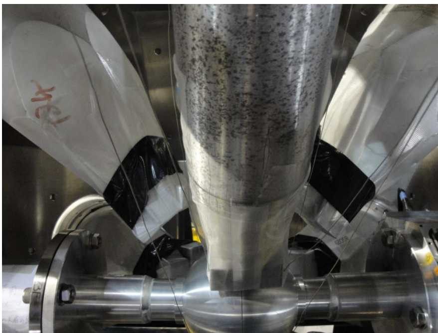
Fig. 4.15 コリメータ取り付け後の写真。テープと針金を用いて Ge 検出器前方に固定している。
